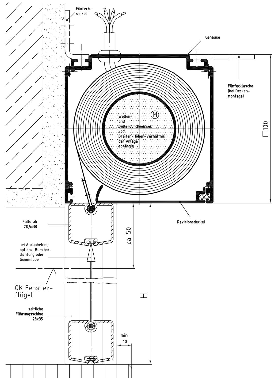
Zeichnung ZIP-MQ 100 – Längsschnitt Systemskizze | ohne Maßstab | sämtliche Angaben in mm
