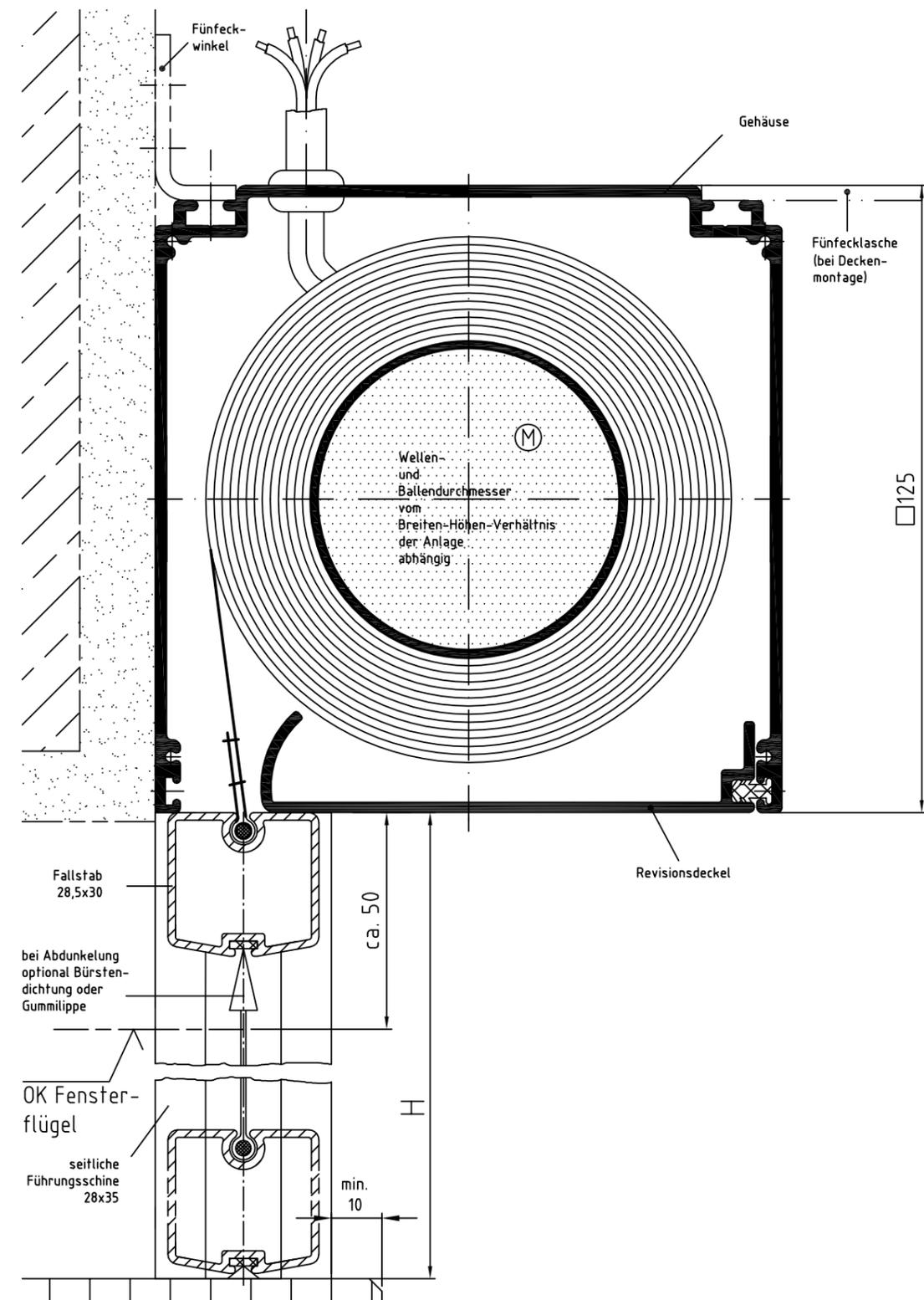
Zeichnung ZIP-MQ 125 – Längsschnitt Systemskizze | ohne Maßstab | sämtliche Angaben in mm
