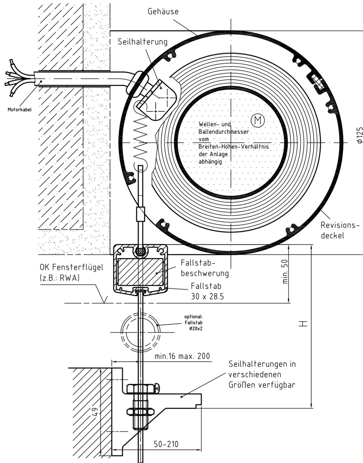
Zeichnung R2-V-MR 125 – Längsschnitt Systemskizze | ohne Maßstab | sämtliche Angaben in mm
