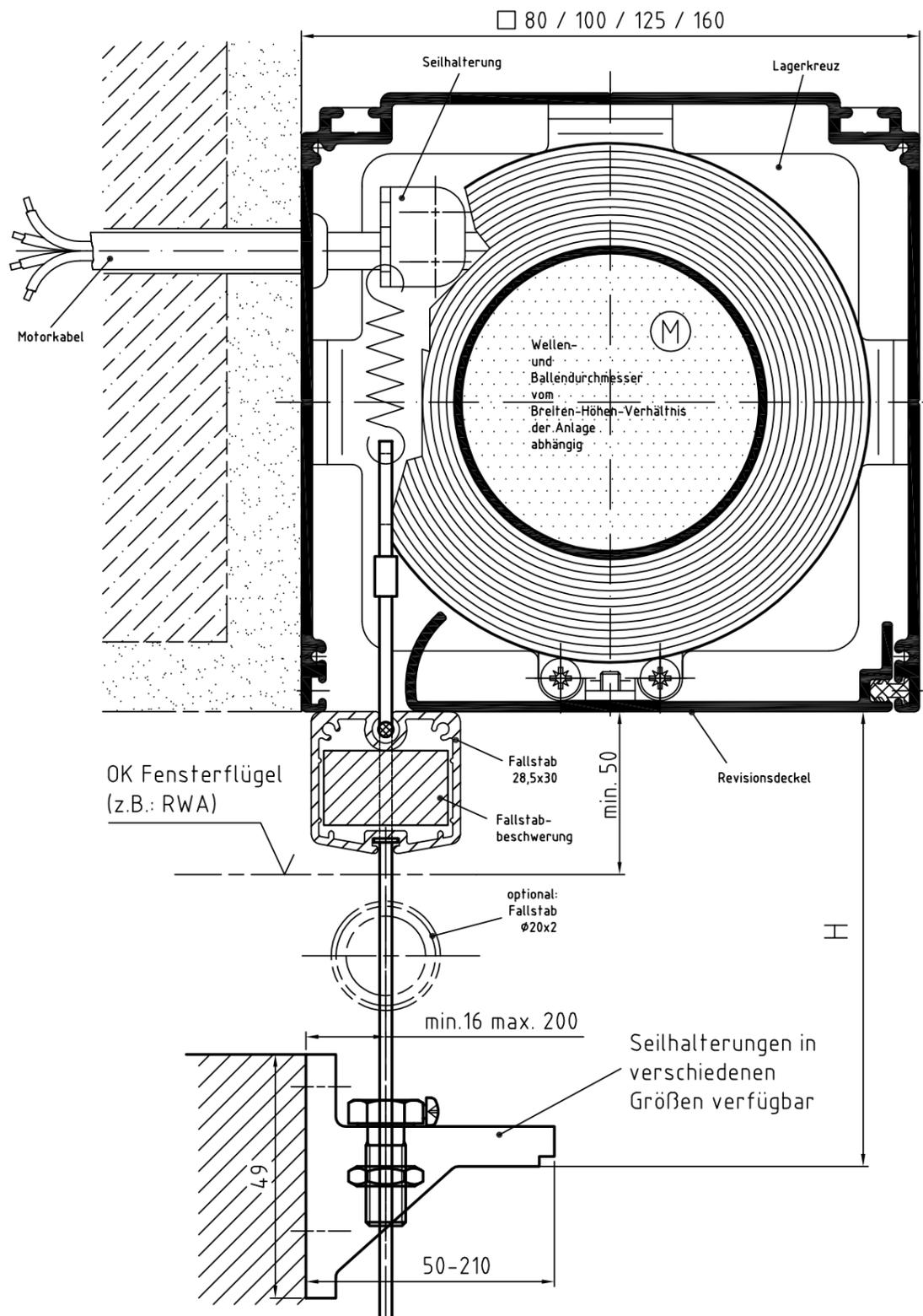
Zeichnung R2-V-MQ – Längsschnitt Systemskizze | ohne Maßstab | sämtliche Angaben in mm
