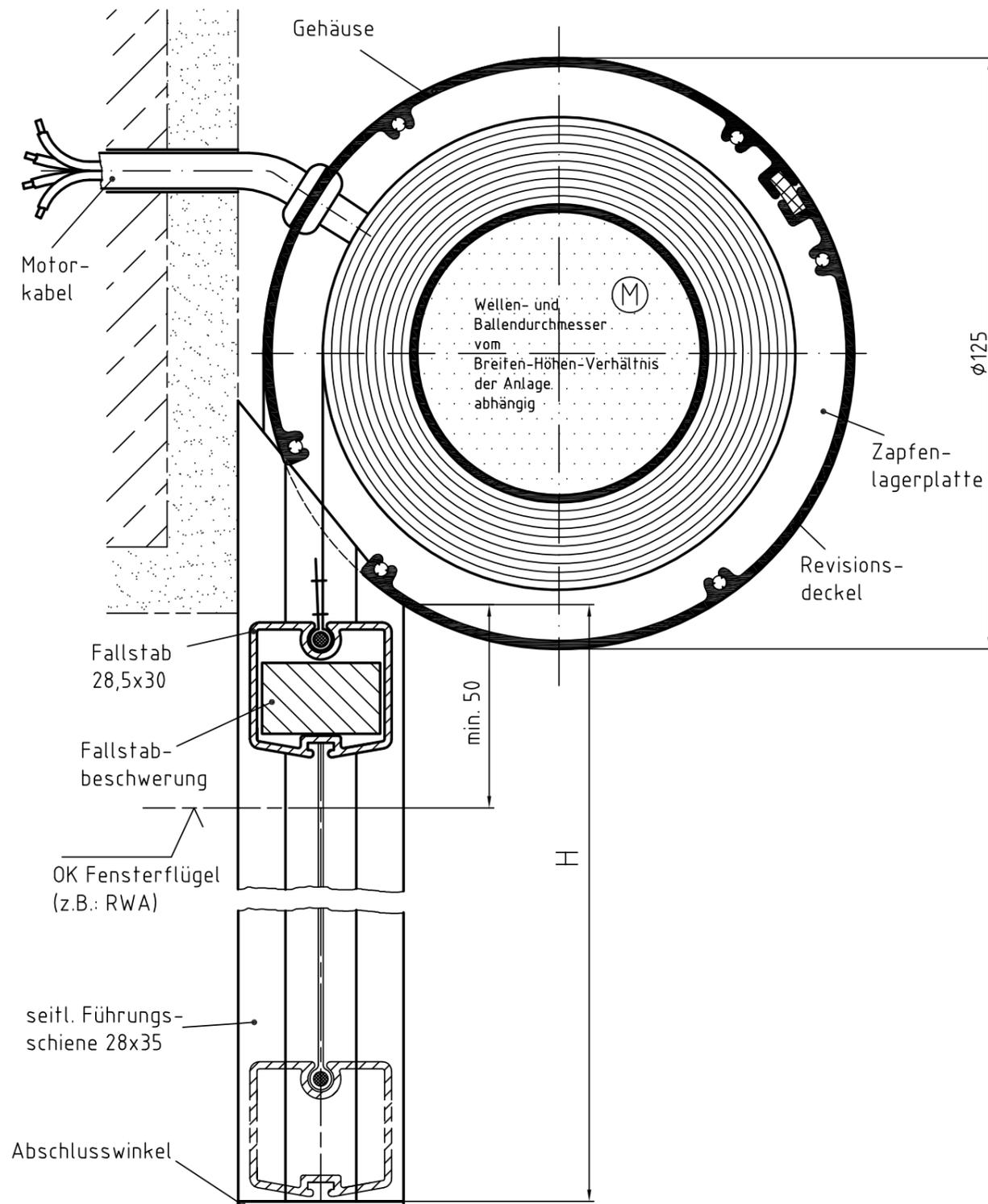
Zeichnung R2-V-MR 125 – Längsschnitt Systemskizze | ohne Maßstab | sämtliche Angaben in mm
