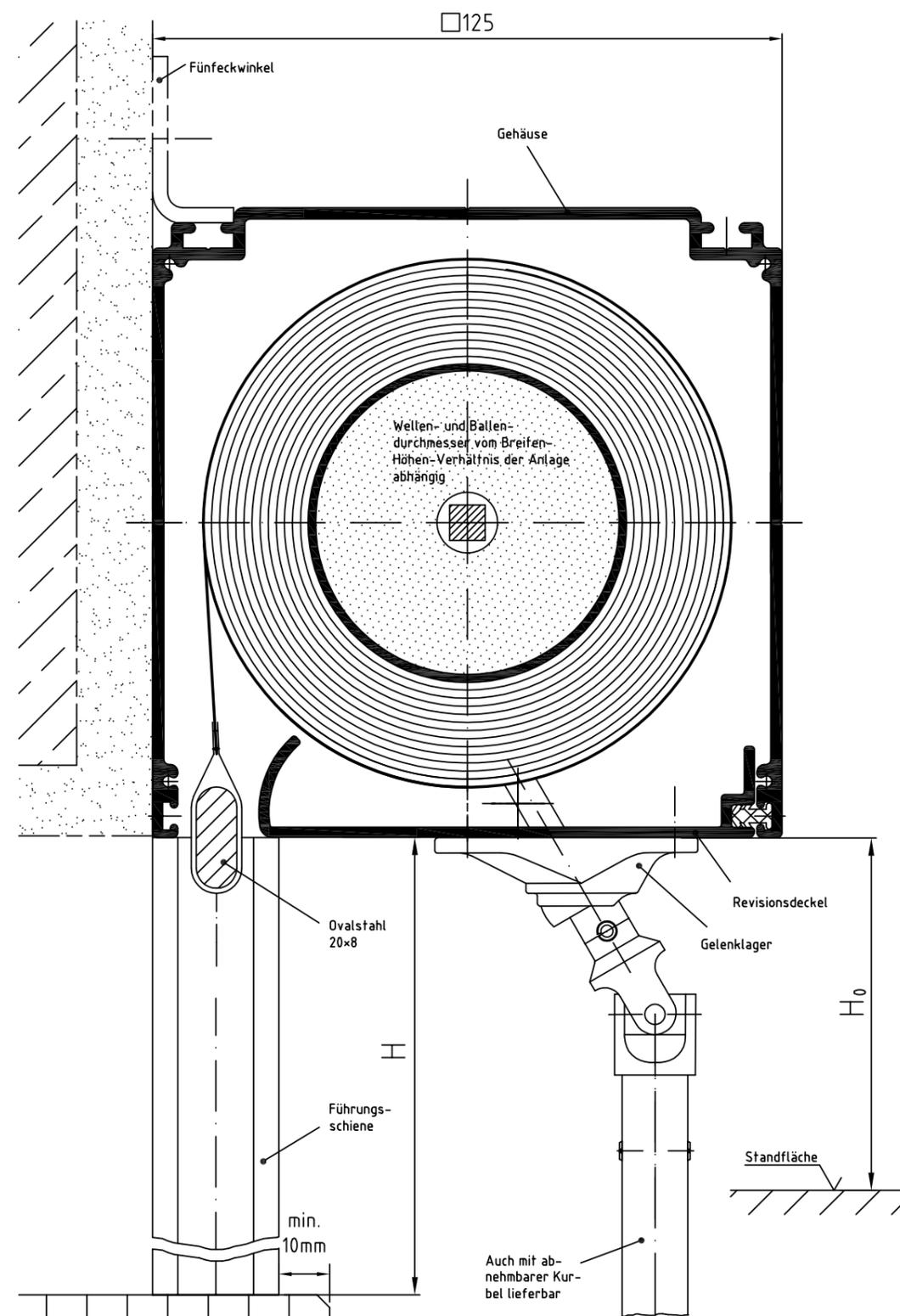
Zeichnung L-GQ 125 – Längsschnitt Systemskizze | ohne Maßstab | sämtliche Angaben in mm
